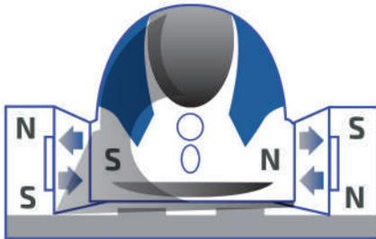
Esquema de funcionamiento de suspensión magnética. [4]
